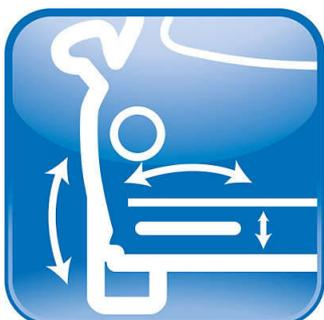
O intervalo de montagem dos módulos aumentou para +/- 40 graus na horizontal, +/- 2 graus na vertical e +/- 32 graus na diagonal.
