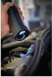
Esta lámpara de inspección LED no solo tiene un haz principal muy potente, sino que también dispone de un detector de fugas UV-A. El detector te ayudará a detectar fácilmente fugas en sistemas de aire acondicionado sin necesidad de herramientas adicionales. Solo tiene que añadir líquido detector de fugas en el sistema de aire acondicionado y aparecerán todas las fugas.
