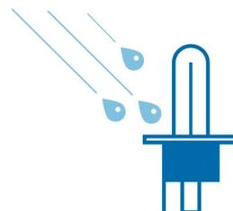
只有採用石英玻璃製成的燈泡 (燈絲溫度 2650°c，玻璃表面溫度 800°c) 可以抵抗瞬間溫差衝擊。反之他牌硬玻璃車燈，當您的愛車燈罩破損或有裂隙，又正行經水坑或下雨之際，若不慎有水滴接觸到高溫的燈泡，就會造成溫度衝擊而產生爆裂。^應用依燈泡類型而異
