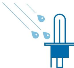
Solo una lámpara encendida fabricada con cristal de cuarzo (filamento a 2.650 °C, cristal a 800 °C) puede soportar cambios bruscos de temperatura; por ejemplo, soporta sin explotar el goteo de agua fría sobre el cristal caliente de la lámpara, algo que puede suceder al conducir con una lámpara delantera rota y si hay agua en el entorno.
