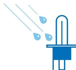
只有採用石英玻璃製成的發熱燈泡 (燈絲 2650° c，玻璃 800° c) 可以抵抗溫度衝擊：當您的車頭燈破損，又開經水坑時，如果有一滴冷水接觸到高溫燈泡，就會造成溫度衝擊。
