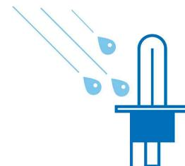
Solo una bombilla encendida fabricada con cristal de cuarzo (filamento a 2 650 °C, cristal a 800 °C) puede soportar cambios bruscos de temperatura; por ejemplo, soporta sin explotar el goteo de agua fría sobre el cristal caliente de la lámpara, algo que puede suceder al conducir con una lámpara delantera rota y si hay agua en el entorno.
