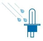
Seules des lampes en verre quartz (filament 2 650 °C, verre 800 °C) peuvent résister à d'importants chocs thermiques, par exemple lorsqu'une goutte d'eau froide entre en contact avec une lampe brûlante alors que vous conduisez avec un phare cassé.
