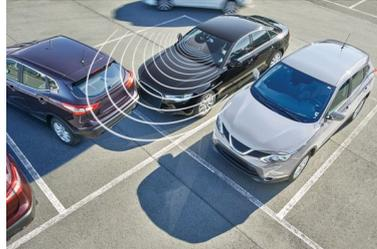
為了全天候持續不斷地保護您的車輛，當您停車時，ADR900 會自動切換至 WaveGuard 監控。WaveGuard 是飛利浦獨特的微波偵測技術，可感應車子前方的狀況，每當檢測到移動物體太過接近您的車時 (例如行人和車輛)，便會開始錄影。之後會自動關機以節省車用電池電力。
