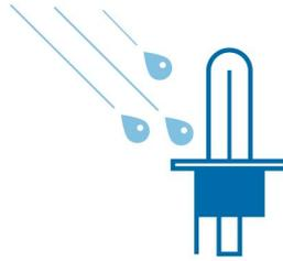
只有採用石英玻璃製成的發熱燈泡 (燈絲 2650°C，玻璃 800°C) 可以抵抗溫度衝擊：例如，當您的車頭燈破損，又開經水坑時，如果有一滴冷水接觸到高溫燈泡，就會造成溫度衝擊。
