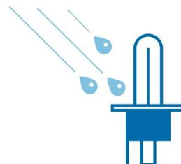
只有石英玻璃材質的燈泡（石英玻璃的燃點為 2650°C，而玻璃的燃點為 800°C）可以抵抗溫度衝擊：在雨中駕駛時，若車頭燈有損壞，冷雨水觸及熱燈泡，便有可能發生此情況。^用途因燈泡類型而異。
