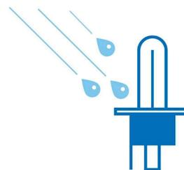
Seules les ampoules en verre de quartz (filament 2 650 °C, verre 800 °C) peuvent résister à d'importants chocs thermiques, par exemple lorsqu'une goutte d'eau froide entre en contact avec une lampe brûlante alors que vous conduisez avec un phare cassé. ^Caractéristique variant en fonction du type d'ampoule.
