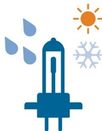
Seules des lampes en verre quartz (filament 2 650 °C, verre 800 °C) peuvent résister à d'importants chocs thermiques, par exemple
