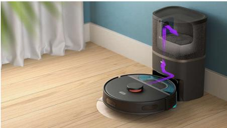
Il robot si svuota automaticamente nell'apposita stazione. La stazione contiene un sacchetto monouso antiallergico da 3,0 litri, in grado di contenere fino a 30 giorni di polvere e altra sporcizia, per offrire fino a 30 giorni senza dover pensare allo svuotamento. Il sacchetto s-bag universale può essere smaltito in modo igienico senza nuvole di polvere, ideale per chi soffre di asma e allergie.
