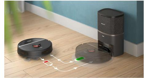
La potente batteria agli ioni di litio da 4800 mAh garantisce un'autonomia massima di 200 minuti, in modo da pulire oltre 150 m con una sola ricarica senza doversi preoccupare di una perdita di potenza. Quando la batteria si scarica, il robot torna automaticamente alla stazione per ricaricarsi. Una volta caricata la batteria, il robot tornerà nel punto in cui si era scaricata la batteria per riprendere la pulizia.
