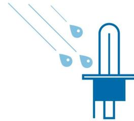
Только лампа из кварцевого стекла (нить накаливания 2650 °C, стекло 800 °C) может во включенном состоянии противостоять резким перепадам температуры: например, при попадании капли холодной воды на горячую лампу, что может произойти, если вы проезжаете по воде со сломанным корпусом фары.
