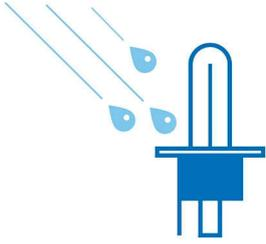
Solo una bombilla encendida fabricada con cristal de cuarzo (filamento a 2.650 °C, cristal a 800 °C) puede soportar cambios bruscos de temperatura: por ejemplo, soporta sin explotar el goteo de agua fría sobre el cristal caliente de la bombilla, algo que puede suceder al conducir con un faro delantero roto y si hay agua en el entorno.
