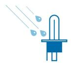
Только лампа из кварцевого стекла (нить накаливания 2650 °C, стекло 800 °C) может во включенном состоянии противостоять резким перепадам температуры — например, при попадании капли холодной воды на горячую лампу, если вы проедете по воде с поврежденным корпусом фары.
