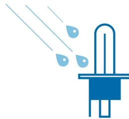
只有石英玻璃材質的燈泡（石英玻璃的燃點為 2650°C，而玻璃的燃點為 800°C），在雨中駕駛時，冷雨水觸及熱燈泡，可能會令車頭燈損壞。
