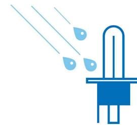
มีเพียงหลอดไฟที่ทำจากแก้วครอบซัลโว (ไส้หลอด 2650 °C และแก้ว 800 °C) ที่สามารถทนต่อการเปลี่ยนแปลงอุณหภูมิทันทีทันใจได้ : เช่น ถ้าเมฆด้าน้ำเย็นตกรอบหลอดไฟที่กำลังร้อน ชื้นอาจเกิดขึ้นได้ เมื่อคุณขับผ่านน้ำบนถนนไฟหน้าที่บ้ารุดอยู่ ^ การใช้งานแตกต่างกันไปตามประเภทหลอดไฟ
