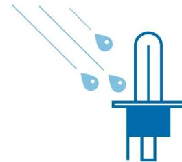
Solo una bombilla ardiendo fabricada con cristal de cuarzo (filamento a 2650 °C, cristal a 800 °C) puede soportar cambios bruscos de temperatura; por ejemplo, soporta sin explotar el goteo de agua fría sobre el cristal caliente de la bombilla, algo que puede suceder al conducir con un faro delantero roto y si hay agua en el entorno.
