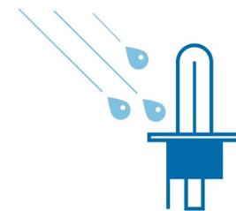
Quando è in funzione solo una lampadina realizzata in vetro al quarzo (filamento a 2650 °C, vetro a 800 °C) è in grado di resistere agli sbalzi termici: se, una goccia d'acqua fredda tocca la lampadina rovente che può accadere quando guidi sotto la pioggia con un faro rotto.
