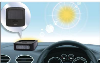
飛利浦無線胎壓偵測系統內建的電池，可透過便利的太陽能板充電。充電後，如果每天使用 2.2 小時，待機時間可維持 3 週之久。您也可以利用 micro USB 電線為電池充電，確保電力供應不致中斷。
