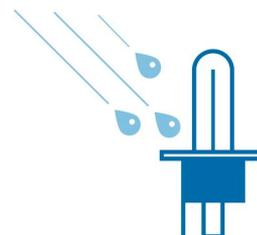
Только лампа из кварцевого стекла (нить накаливания 2650 °C, стекло 800 °C) может во включенном состоянии противостоять резким перепадам температуры — например, при попадании капли холодной воды на горячую лампу, если вы проедете по воде с поврежденным корпусом фары.
