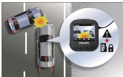
飞利浦 ADR610s 随附 3 轴重力传感器模块，可检测移动并触发紧急录制模式。在发生超过特定力阈值的碰撞时，本设备将锁定该视频剪辑，以防止被覆盖。然后，此重要的视频可安全地保存在耐用的存储卡上。R85
