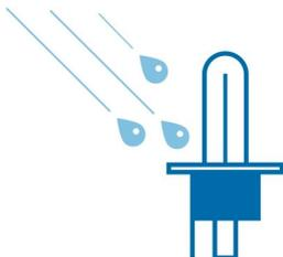
Apenas uma lâmpada feita de vidro de quartzo (filamento de 2650 °C, vidro de 800 °C) pode resistir a choque térmico, como, por exemplo, se uma gota de água fria tocar a lâmpada quente, que pode ocorrer quando você conduzir através da água com uma unidade de farol quebrada.
