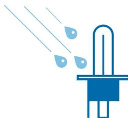
Quando è in funzione solo una lampadina realizzata in vetro al quarzo (filamento a 2650 °C, vetro a 800 °C) è in grado di resistere agli sbalzi termici: se, una goccia d'acqua fredda
