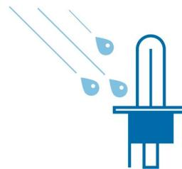
只有採用石英玻璃製成的發熱燈泡 (燈絲 2650°C，玻璃 800°C) 可以抵抗溫度衝擊：當您的車頭燈破損，又開經水坑時，如果有一滴冷水接觸到高溫燈泡，就會造成溫度衝擊。
