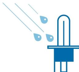
Solo una lámpara encendida fabricada con cristal de cuarzo (filamento a 2.650 °C, cristal a 800 °C) puede soportar cambios bruscos de temperatura: por ejemplo, soporta sin explotar el goteo de agua fría sobre el cristal caliente de la lámpara, algo que puede suceder al conducir con un faro delantero roto y si hay agua en el entorno.
