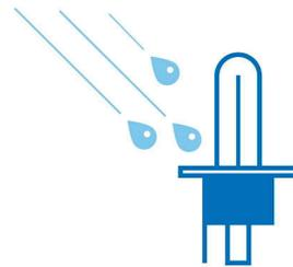
只有石英玻璃材質的燈泡（石英玻璃的燃點為 2650° C，而玻璃的燃點為 800° C）可以抵抗溫度衝擊：在雨中駕駛時，若車頭燈有損壞，冷雨水觸及熱燈泡，便有可能發生此情況。<sup>^</sup>用途因燈泡類型而異。
