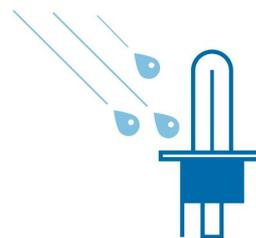
Seules les ampoules en verre de quartz (filament à 2 650 °C, verre 800 °C) peuvent résister à d'importants chocs thermiques, par exemple lorsqu'une goutte d'eau froide entre en contact avec une lampe brûlante alors que vous conduisez avec un phare cassé. ^Caractéristique variant en fonction du type d'ampoule.
