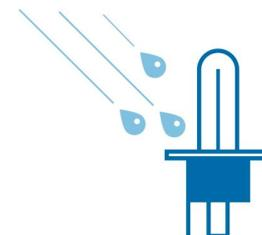
Nur eine brennende Glühlampe aus Quarzglas (Glühfaden 2.650 °C, Glas 800 °C) kann extremen Temperaturschwankungen widerstehen, wenn z. B. ein Tropfen kaltes Wasser auf die heiße Glühlampe fällt.
