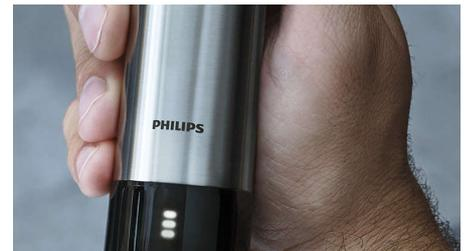
O indicador de bateria indica quando o aparador está carregado, a carregar ou quando precisa de ser ligado à corrente elétrica. Também indica a carga restante através de 3 barras simples.
