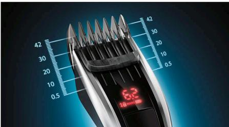
Verwenden Sie die Bedienelemente, um die aus mehr als 60 Längeneinstellungen gewünschte Länge auszuwählen und einzustellen. Verwenden Sie den Kammaufsatz zum Schneiden mit exakten 0,2-mm-Schritten zwischen 1 und 7 mm bzw. 1-mm-Schritten zwischen 7 und 42 mm. Ohne Kammaufsatz erzielen Sie einen 0,5-mm-Schnitt.
