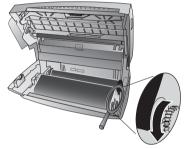
**7** 关好设备。将进纸器卡入至进纸机构后面的开口内。再次将纸装入。
