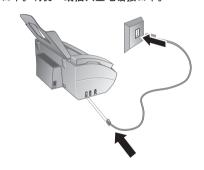
如果您将设备按电话系统分机连接,则必须将 其设置为分机工作模式(请参见 19 页上的 ″线 路类型及辅助装置 ″ 章节 )。
