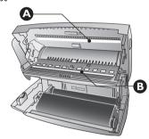
5 使用柔软的无绒布沾取适量的清洁酒精 (96%),清洁进纸辊子(A)和进纸辊子支撑垫的下侧(B)。转动进纸辊子,整个辊子必须都要清洁。
