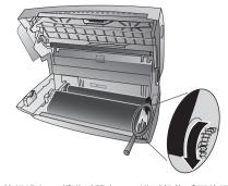
5 关好设备。将进纸器卡入至进纸机构后面的开口内。再次将纸装入。
