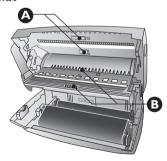
6 关闭扫描器盖及自动进稿器壳体。两个支撑板均 应牢固卡入就位。
