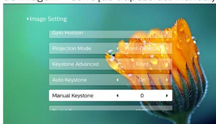
Certifique-se de que selecciona *Projection Image Setting - Keystone Advanced - Front* (Definição de Projecção de Imagem - Trapezoidal Avançado - Frontal) para ativar a opção *Manual Keystone* (Correção trapezoidal manual).
