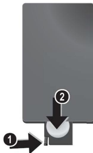
2. Introduzca la nueva pila con el polo positivo tal y como aparece en la parte trasera del mando a distancia.
