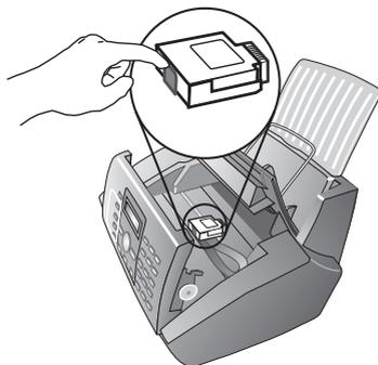
4 Retire el cartucho tirando de él inclinado hacia delante y sacándolo hacia arriba.
