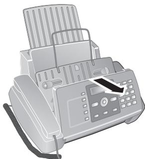
2 Abra el compartimento del cartucho pulsando la esquina superior derecha del depósito de documentos (flecha) y basculándolo hacia atrás. Encaje el depósito de documentos por completo.
