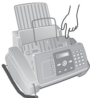
3 Empuje hacia delante el dispositivo de bloqueo en el centro del soporte y levante el cartucho.
