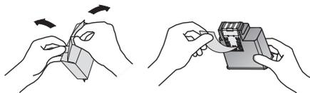
6 Coloque el cartucho en el compartimento con el extremo de color hacia delante y con los contactos hacia abajo.
