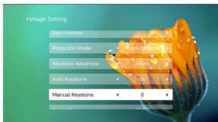
Чтобы активировать опцию *Manual Keystone* (Ручная коррекция трапецидальных искажений), выберите пункты *Projection Image Setting - Keystone Advanced - Front* (Настройка изображения проектора - Дополнительная коррекция трапецидальных искажений - Спереди).
