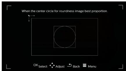
2 В интерфейсе 4-угловой коррекции нажмите **OK**, чтобы выбрать угол изображения, а затем используйте кнопки **◀/▶**, чтобы отрегулировать положение по горизонтали, и кнопки **▲/▼**, чтобы отрегулировать положение по вертикали. Повторите этот шаг, чтобы настроить значения позиционирования других углов изображения, если это необходимо.
