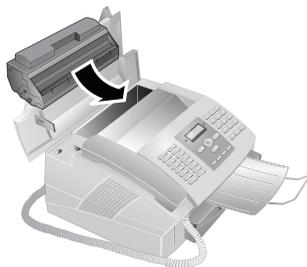
8 关闭罩盖。确保罩盖两侧都牢固卡入就位。
