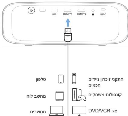
2 עברו אל תפריט ההגדורות של המקרן באמצעות לחיצה על לחץ ה- בשלט רחוק או על לחץ ה- על המקרן. לאחר מכן, בחרו מכון, בחרו Input (קלט) < HDMI1 > או HDMI2.
