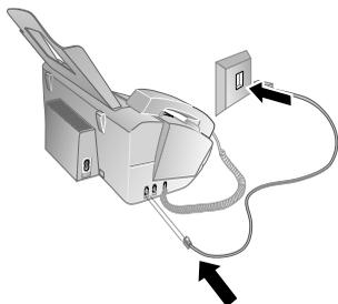
Si conecta su aparato como centralita a un equipo telefónico, deberá configurarlo para el funcionamiento como centralita (vea también el capítulo Conexiones telefónicas y aparatos adicionales, página 43).
