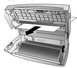
4 Tournez la roue d'engrenage bleue vers l'avant pour tendre le film encreur. Le film encreur ne doit pas présenter de plis.
