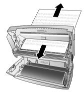
5 Fermez le couvercle du scanner et de l'alimentation automatique de document. Les deux fixations doivent se verrouiller fermement.
