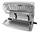
4 Retirez les deux rouleaux de l'appareil. Le film encreur usagé ne peut plus être réutilisé.
