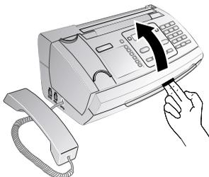
**⚠** Rasten Sie den Deckel des Gerätes vollständig ein, wenn Sie das Gerät öffnen. Sie können sich verletzen, wenn der Deckel zufällt, während Sie am Gerät arbeiten.
