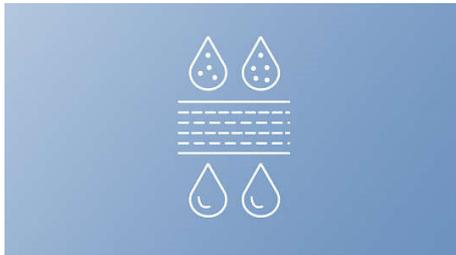
4-этапная система фильтрации задерживает широкий ряд загрязняющих веществ, обеспечивая долговечность и производительность. Фильтр СР задерживает большие частицы и устраняет хлор, пестициды и химические вещества. Затем фильтр RO устраняет полностью растворившиеся в воде твердые вещества. После этого вода проходит через минерализационный фильтр, где насыщается минералами и получает более приятный вкус.
