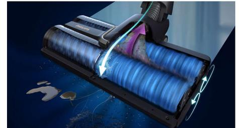
Dvije iznimno meke snažne četke od mikrovlakana rotiraju se u smjeru suprotnom od kazaljke na satu pri brzini od 4500 okr./min. Pri toj visokoj brzini prljavština se podiže s poda i odvodi izravno u uređaj, čime se snažne četke neprestano čiste pa nikada ne morate ispirati i cijediti prljavu krpu za čišćenje! Za optimalno čišćenje preporučuje se zamjena snažnih četki svakih 6 mjeseci.
