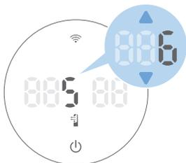
Na função de **ventilação/circulação**, prima o botão  $\Delta/\nabla$  para ajustar a velocidade da ventoinha, que varia entre 1 e 10.
