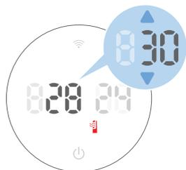
Na função de **aquecimento**, prima o botão  $\Delta/\nabla$  para ajustar a temperatura, que varia entre 1 °C e 37 °C.
