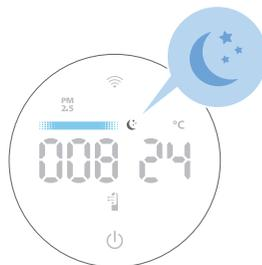
**Modo Sono (☾):** o aparelho funciona silenciosamente a uma velocidade reduzida. Após 3 segundos, a luz do ecrã desliga-se.
