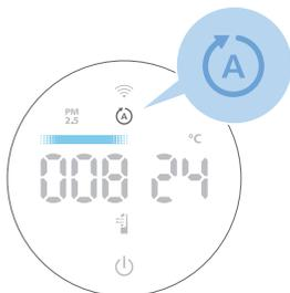
**Automático (A):** o aparelho ajusta automaticamente as definições para proporcionar o melhor desempenho.
