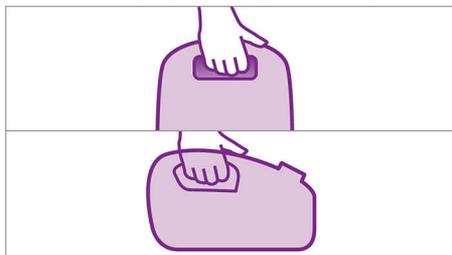
Questo aspirapolvere dispone di due maniglie da trasporto. Quando è sulle ruote, è presente una maniglia superiore per spostare agevolmente l'aspirapolvere senza piegarsi troppo. La seconda maniglia sulla parte anteriore dell'apparecchio consente di metterlo agevolmente in posizione verticale.
