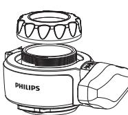
2.取下散水式金属起泡器
