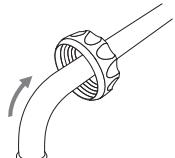
4.根据龙头管直径选择合适的A型适配器，扣到龙头出水口处；
