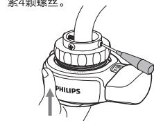
6.将新的连接螺母紧紧拧到切换器外壳上，确保橡胶垫圈与水龙头贴合紧密，防止漏水。
