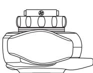
5.从下往上将切换器推到水龙头上，然后用螺丝刀均匀地旋紧4颗螺丝。
