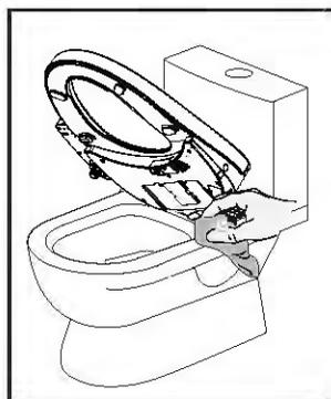
●清洁保养本产品时，请先拔出电源插头，切断电源，关闭角阀开关以免发生漏水、触电等危险。
