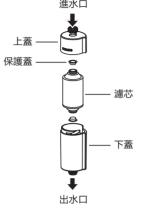
圖示方向旋下 ∠ 花灑軟管,將過 蓋,取出濾芯, 瀘器進水□與混 去掉濾芯兩端的 水閥出水口連接 保護蓋,重新安 並旋緊; 重新安 裝好濾芯和上蓋 裝好濾芯和上蓋
