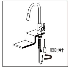
(3) 将冷热进水软管分别接在冷热进水角阀上。
